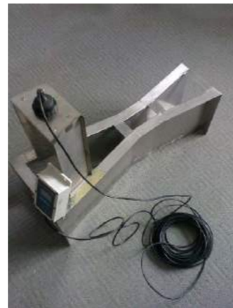
巴歇尔槽安装实物图
